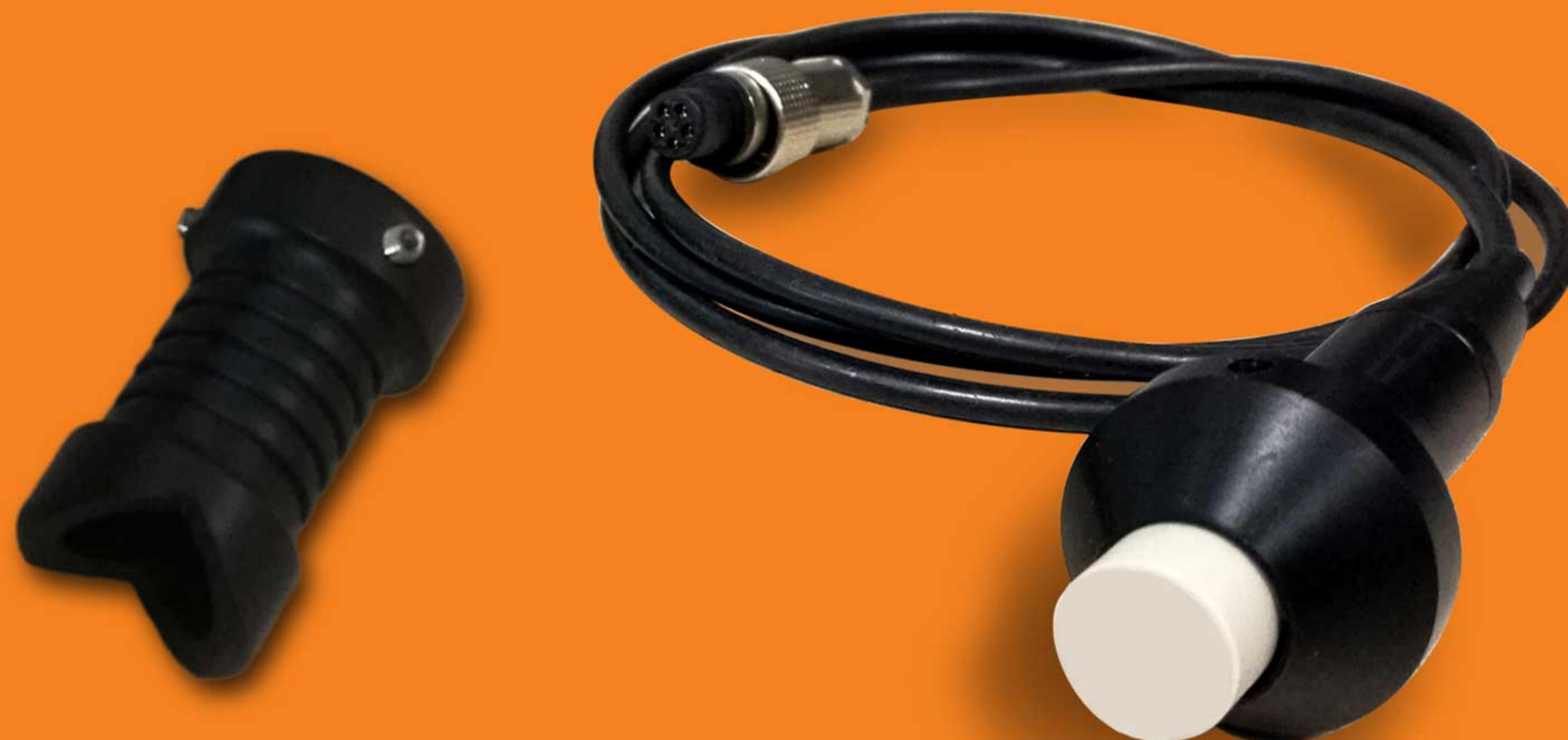
工作频率决定导电仪能测试的最小厚度,Sigma2008B型特制直径 $\varphi 8\text{mm}$ 频率500KHz的小径高频探头,能测试最小厚度可达到0.28mm左右,可适用超薄件的测量。并通过专业定制,在保持高频率的情况下极限的缩小了探头尺寸,各种特殊小件材料都能应对自如。
