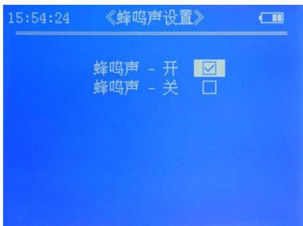
蜂鸣声可提示按键操作，测量成功，电池低压。
