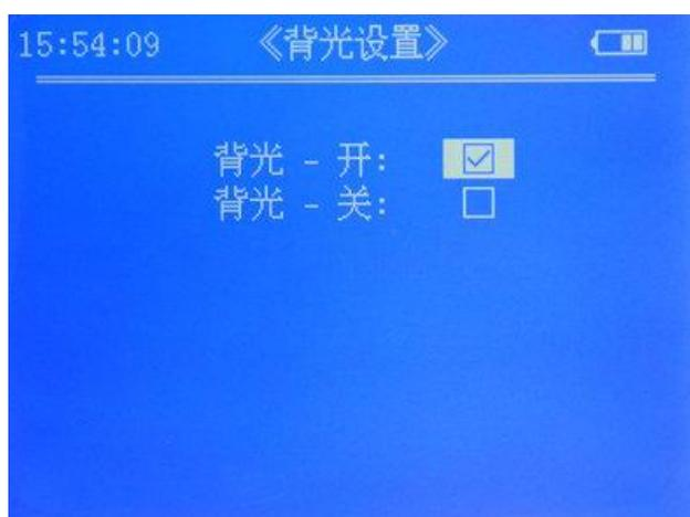
背光设置可控制屏幕背光的开与关，当光线不足或无法看清屏幕显示内容时，建议开启背光。设置时按“↑”或“↓”键选择，再按“OK”确认并保存设置，设置立即生效，屏幕的背光立即开启或关闭，并返回菜单界面；若按“ESC”键则不保存直接返回菜单界面。
