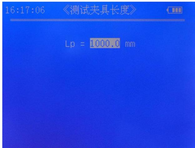
测试夹具选择仅在“导线综合参数测量”和“电导率/电阻率测量”主界面有效。
